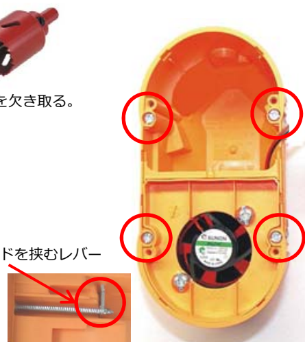
図④ ○印の4ヶ所のビスを回すと、石膏ボードを挟むレバーが上がってきます。
