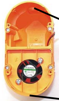
② 3芯ケーブルを通す穴をこの位置にΦ5mm程度
