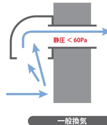
一般的なフードの多くは、上部が閉まっている構造のため空気の抜け道がなくなります。そのため、強風がフードに入るとフード内の静圧が上がり、冷たい空気だけでなく、大きな風切音や粉塵などのゴミと一緒に部屋の中に入り込んでしまいます。
