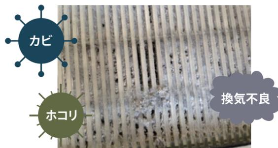
ダクト式の熱交換換気の熱交換素子の多くは薄型紙（和紙）の層築で作られています。このような素材の素子は耐久性が低く、水洗いを行うことが出来ません。そのため、ホコリが溜まって目詰まりを起こしたり、水分や汚れによる劣化も早く定期的に交換のコストがかかってしまいます。
