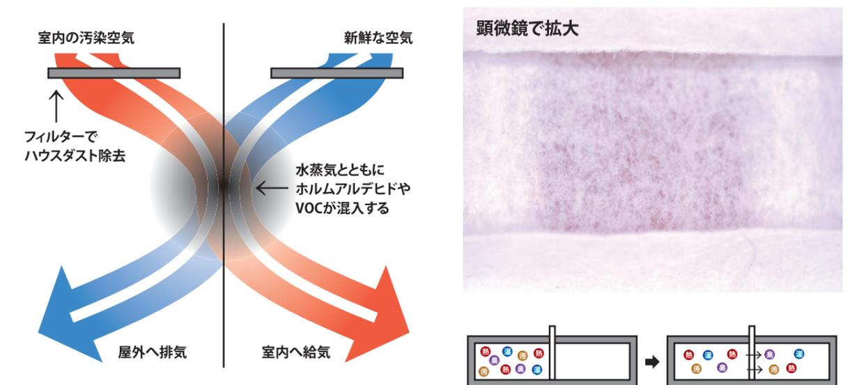
水蒸気と一緒にトイレの臭気、VOC、CO<sub>2</sub>などの汚染も紙フィルターを通過して給気とともに部屋に戻っていきます。また、給排気間の空気の漏れもあります。それは熱交換効率補正係数に表示されており、大体の商品には10%の漏れがあることがわかります(補正係数0.9)。
