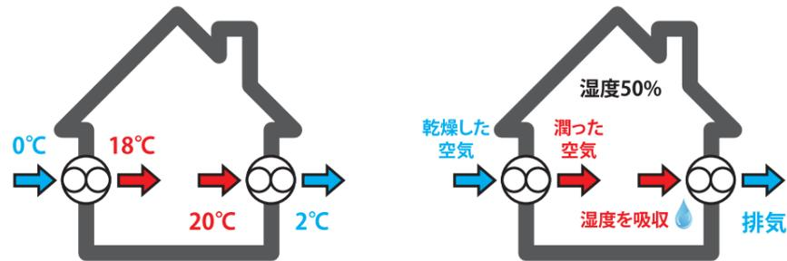
ダクトレス熱交換換気の「せせらぎ®」は、効率的に熱交換を行い、最大交換率93%の熱を回収します。熱だけでなく湿度もコントロール。一般換気と同じく配管なしの簡単・衛生的・省スペースな構造で、部屋の温度・湿度を1年中快適な状態に保ちつつ、新鮮な外気を取り込んでいきます。
