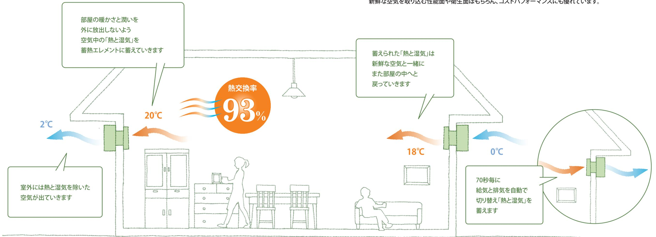
日本初 蓄熱方式のダクトレス熱交換換気システムとして特許を取得しています。
