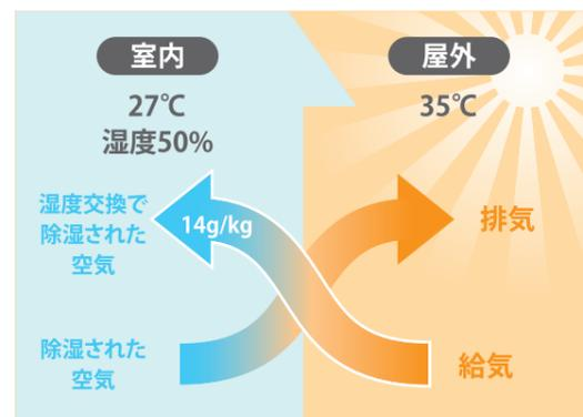
湿度回収及び湿度センサーにより湿度を調整します。
