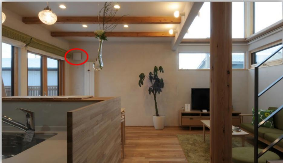
室温ばかりではなく、湿度もしっかりコントロールしてくれるのが『せせらぎ®』の良いところ！冬場は窓に結露が溜まりやすいものですが『せせらぎ®』には、内蔵されている**多孔質セラミック製蓄熱エレメント**が空気の熱とともに空気中の水蒸気も捕集してくれるため、**調湿作用**の性質があり、**適度に近い湿度**を保ってくれます。
