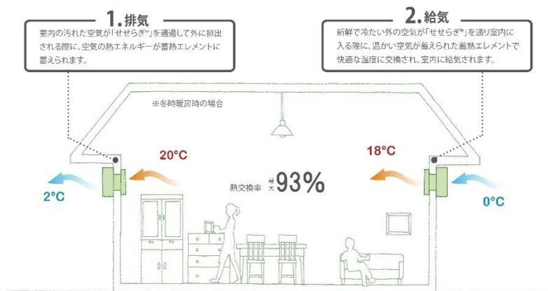
PEJスーパー換気「せせらぎ」システムは高効率の全熱交換換気システム（換気分類：第一種）です。自然の空気を給気し室内の熱と湿気を回収します。集中コントローラー1基につき最大8台までの換気ユニットを同期し、連動運転ができます。
